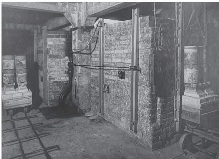
Wysuszone i przycięte na wymaganą długość pręciki wypalane są w grafitowych tyglach w temp. 1350°C
