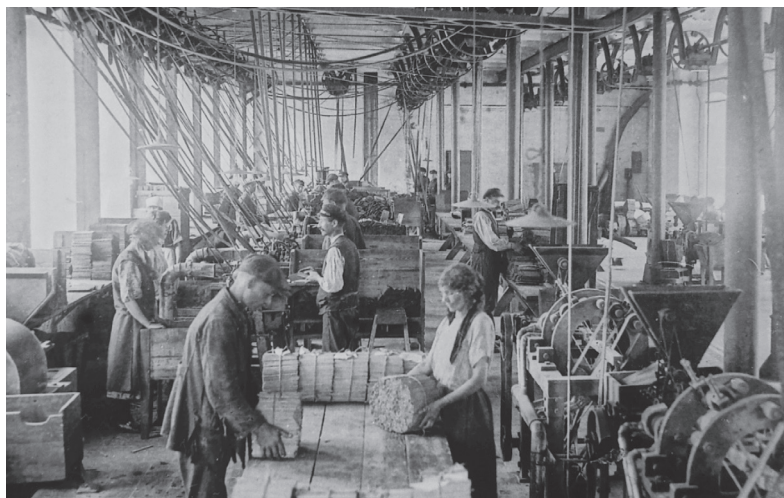
Po lewej strugarki wycinające sześć ołówków ze sklejonych deseczek. Z prawej szlifierki wygładzające ołówki przed lakierowaniem
