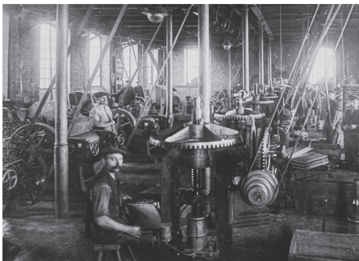
Mechaniczne prasy do wyciskania nici grafitowych i na barwne kredki. Tłok pod ciśnieniem do 100 atm przez otwór kalibrowany wyciska nici ze stalowego cylindra
